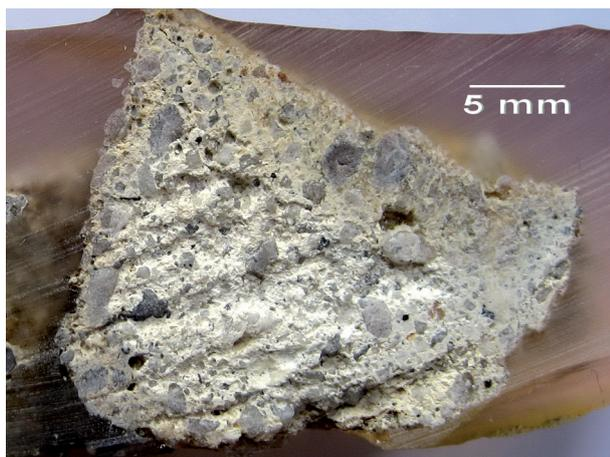
**Figura 1.** Superficie de corte en un mortero clase I (Nº 5), donde se aprecian abundantes granos de cuarzo de tamaño variable, algunos poros y el ligante de color blanco.
